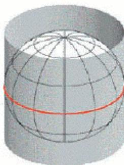
Résultat de la projection d'une surface sphérique sur un cylindre.
