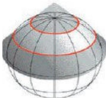
Résultat de la projection d'une surface sphérique sur un cône. Dans une projection conique, un cône est placé sur le globe, tangent sur un parallèle, et avec un point d'origine de lumière au centre du globe qui projette les éléments du globe sur le cône. Le cône est ensuite découpé au niveau du méridien convenu, et drapé sur une surface plane ayant la forme d'un cercle, auquel il manque un secteur.
