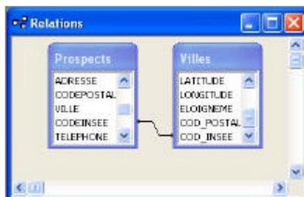
Ce type d'outil permet d'appliquer les schémas conceptuels de manière assez fluide, tout en demandant une rigueur importante dans la mise en place. Des dysfonctionnements dans l'organisation des tables, la définition des attributs, peut entraîner des erreurs dans l'utilisation de la base.
