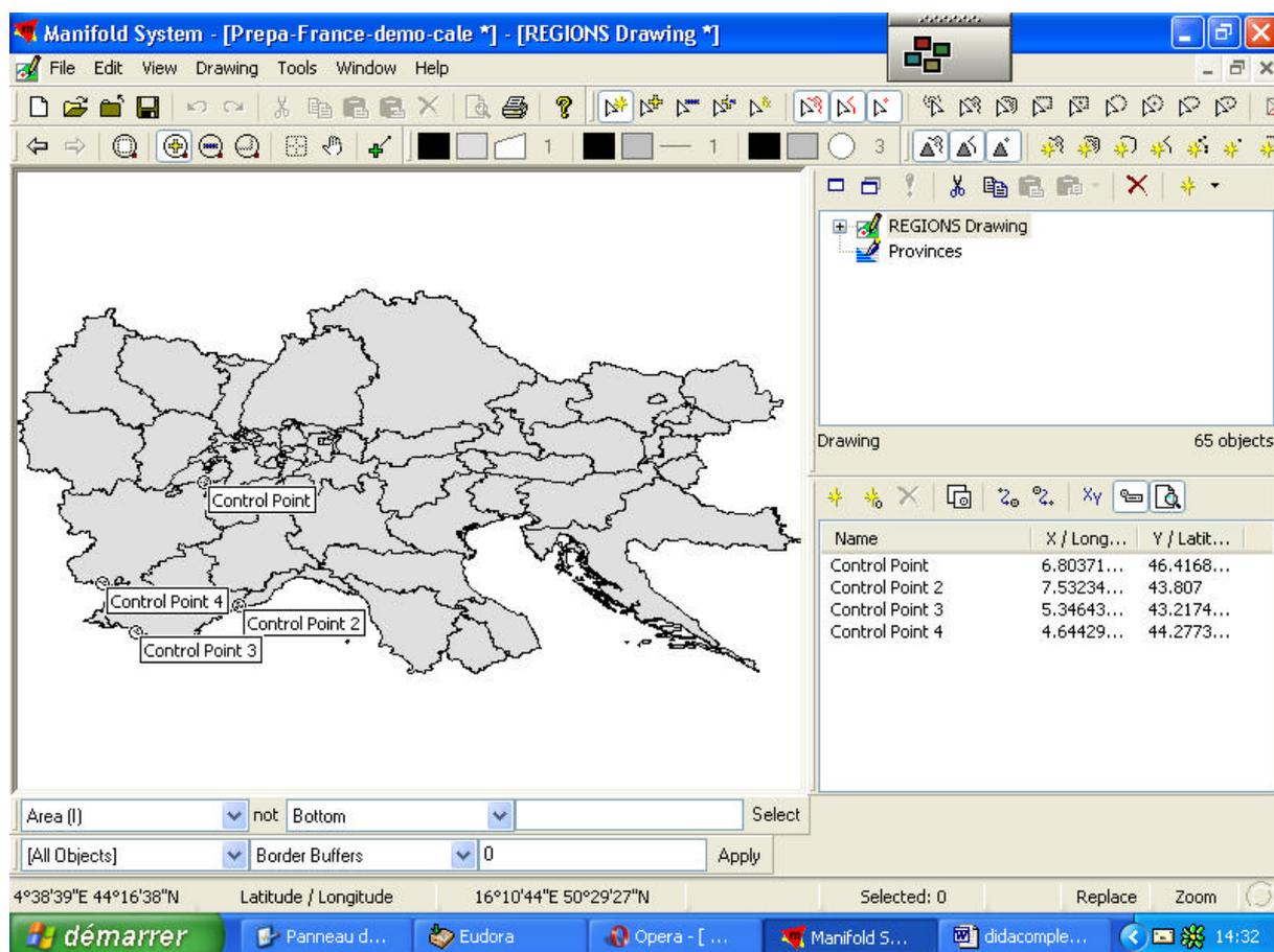
L'image a alors des coordonnées géographiques, souvent au prix d'une déformation, et il devient possible de l'exploiter avec les autres calques, puisqu'elle se trouve dans un système de référence géographique similaire.
